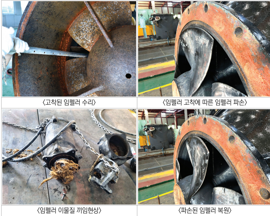
〈그림 3〉 임펠러 이물질 끼임 및 고착으로 인한 피해 사례
